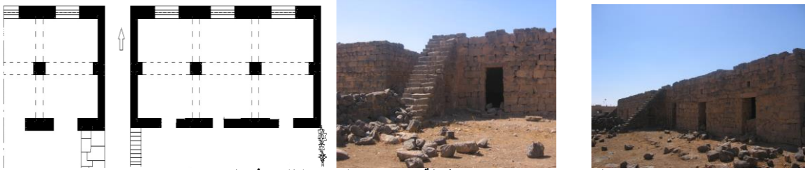
الصورة (15),(16): توضح طريقة تصميم بناء المسكن التقليدي في الباعج.
