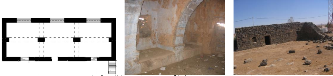
الصورة (17),(18) توضح طريقة تصميم بناء المسكن التقليدي في الباعج
